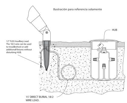
Asegure la fixtura con la estaca de manera que enrosque la cuerda de ½" de la fixtura con la inserción de ½" de la estaca. Mientras mantienen fijo la fixtura gire la estaca hacia la izquierda hasta que quede apretado. No apriete demasiado. Permita que los cables giren libremente mientras esta apretando la fixtura y estaca.
